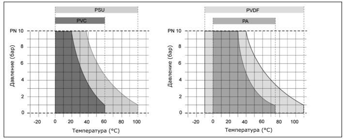
Приведенные значения давления/температуры соответствуют расчетному параметру срока эксплуатации на 20 лет при установленном давлении для неагрессивных жидкостей (DIN 2403), в отношении которых материал является химически стабильным.
