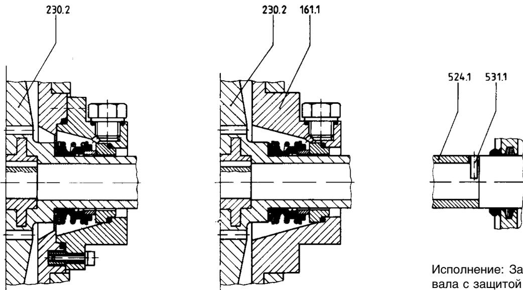
Исполнение: со сварной защитной гильзой вала
